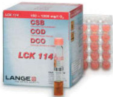
Abb 1. Mit dem LANGE Küvetten-Test CSB wird die Abbauleistung der AK-Filter bestimmt
