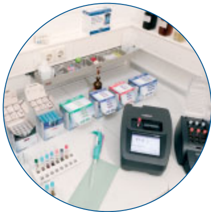
Abb. 6: Mit LANGE Küvetten-Tests werden im Sickerwasser neben CSB außerdem bestimmt: \text{NH}_4 , AOX, \text{NO}_3 , \text{NO}_2 , \text{PO}_4 , N ges.
